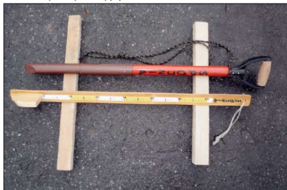
■ Przyrząd zwany „wykałaczką” – służący do sprawdzania wytrzymałości lodu
